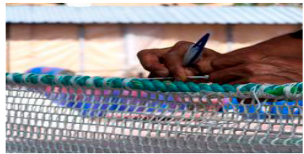
Figure 36 - Illustration relative à la fabrication d'un enclos. Assemblage des différentes parties du filet qui sont cousues autour d'une corde de 10 ou 12 mm
